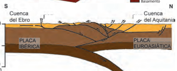
Figura 3. Corte interpretativo realizado a partir de los datos aportados por el perfil sísmico ECORS-Arzacq, modificada de Teixell (2000)
