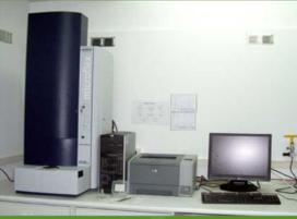
El **Servicio de Difracción de Rayos X** permite la determinación de la estructura molecular, así como el análisis detallado de la densidad de carga, de muestras monocristalinas. Dispone de dos difractómetros automáticos de nueva generación equipados con radiación de Cu y Mo, pudiendo realizar medidas a baja temperatura (hasta 30 K).
