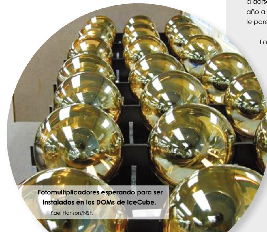
Fotomultiplicadores esperando para ser instalados en los DOMs de IceCube.
