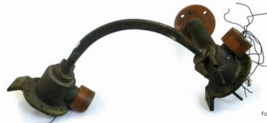
**Tubo por el que circulaban los iones desde la cámara de ionización al colector.**
